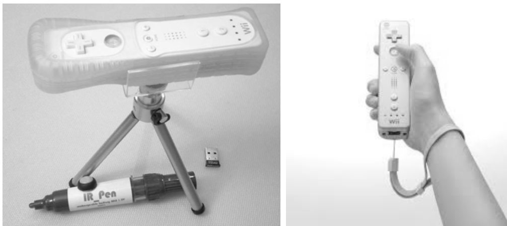
Слика 1. Wiimote контролер (даљински управљач) и инфрацрвена оловка
