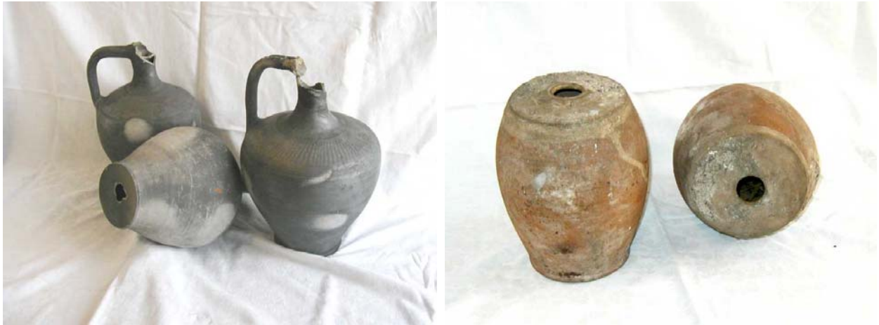
Slika 1.3 - Fotografije akustičkih rezonatora izvađenih iz svodova Gornje crkve u Sremskim Karlovcima (levo) i ruševina crkve u selu Komorane (desno)
